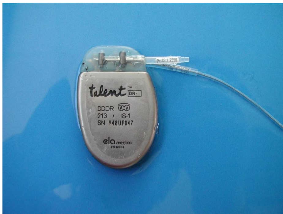
FIGURA 2. Generador de marcapasos diseñado para funcionar en configuración DDDR.
